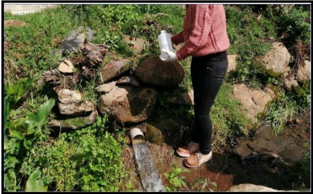
**FOTOGRAFIA N°5 SE OBSERVA LA TOMA DE MUESTRA EN LA SALIDA DE LA PLANTA DE TRATAMIENTO PARA DETERMINAR LA CALIDAD DE AGUA QUE SALE.**
