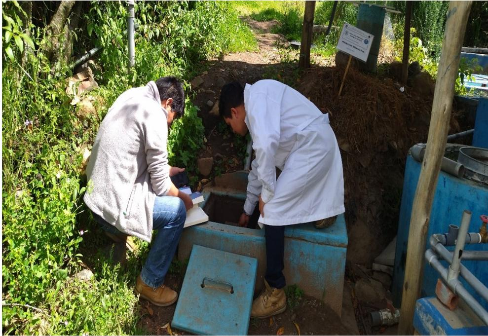
**Fotografía 43:** medición y control de caudal en la última semana se monitoreo en la entrada del humedal horizontal y vertical, donde se observa el ingreso constante de agua residual al sistema.
