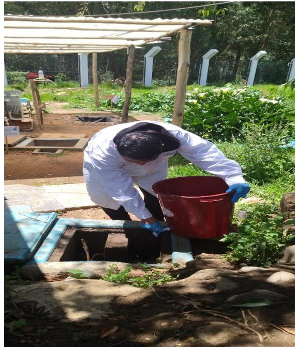
**Fotografía 30:** apuntes de la toma de conductividad de la medición del tiempo de retención hidráulica en humedal horizontal y vertical
