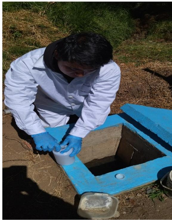
**Fotografía 19 y 20: Toma de la muestra de sustrato en Humedal horizontal y vertical.**
