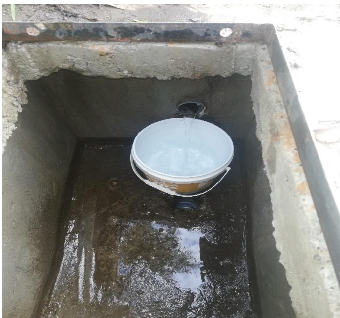
Nota. Se observa, aforo del caudal en tiempo de estiaje en el punto de captación (2021).
