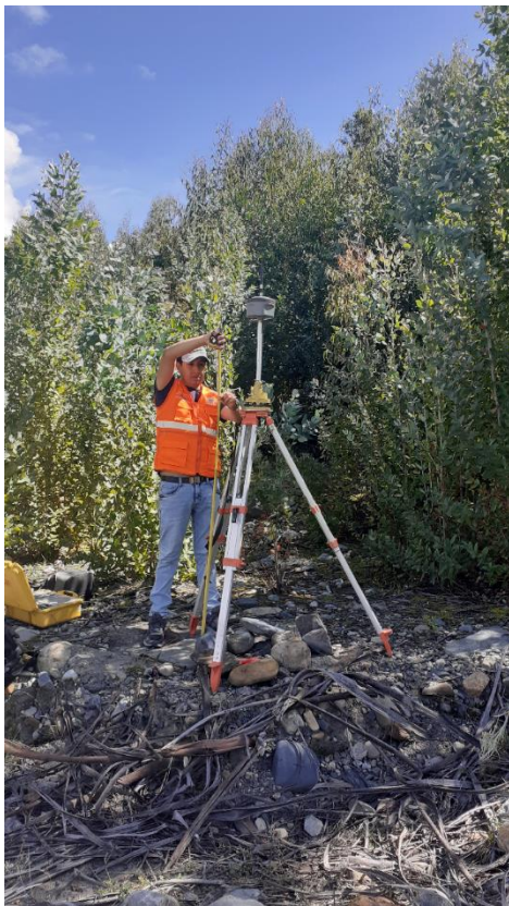
Nota. Medición de altura del equipo.
