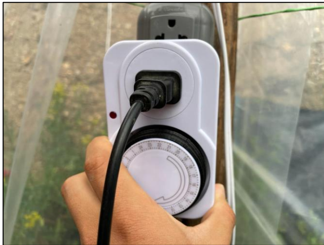
Fotografía N° 15- 16: Prueba del timer y de los microaspersores
