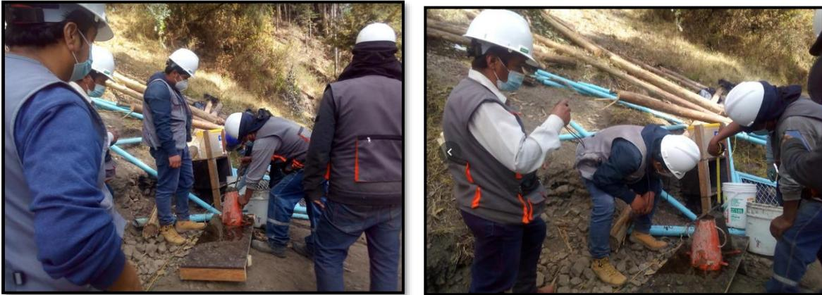
*Nota.* Captura fotográfica de la realización del ensayo del cono de Abrams.
